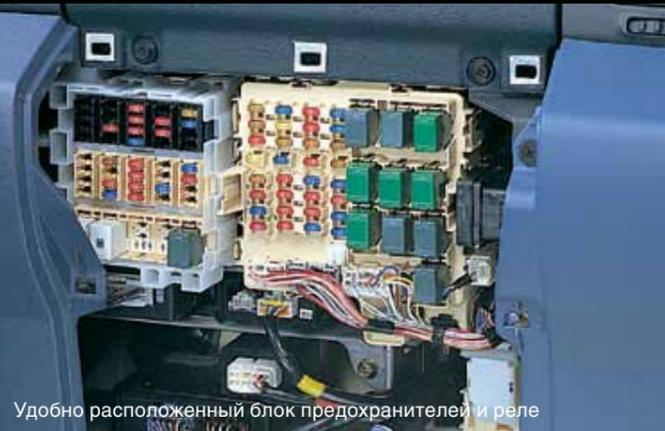
Удобно расположенный блок предохранителей и реле
