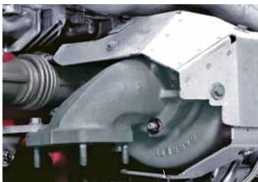
Турбокомпрессор с механизмом изменения геометрии выпускной части – позволяет получить наддув в широком диапазоне оборотов
